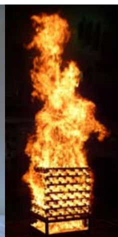
A 火災の代表的な火災モデルであるクリップモデルの燃焼写真。
